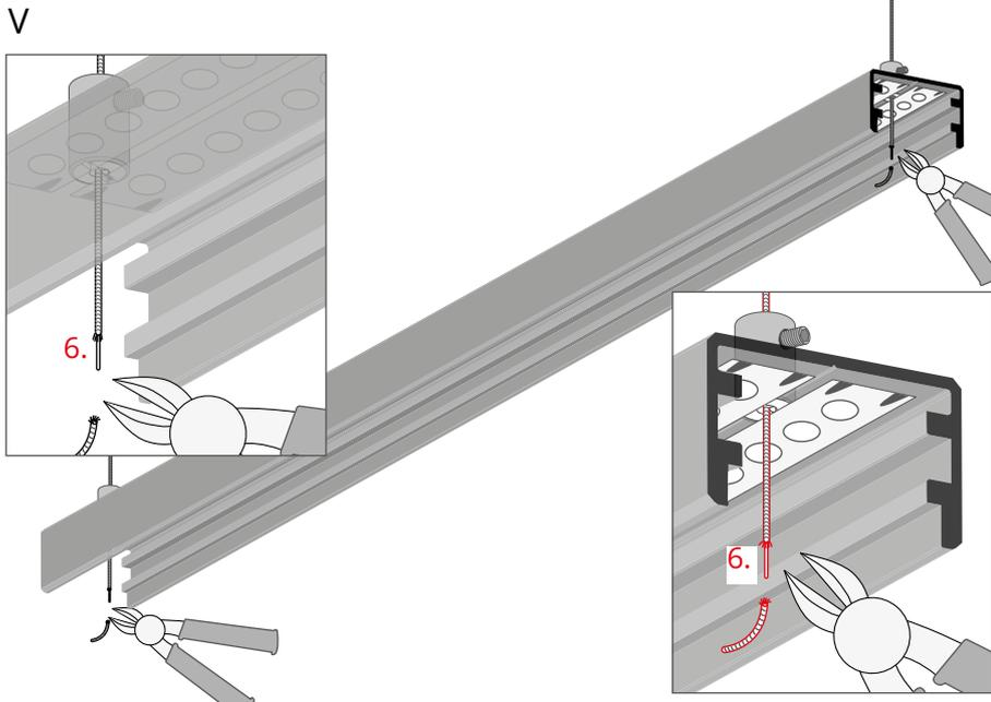
Expose the cable cores (6).
